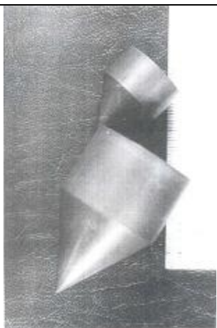
Рис. 14. Кумулятивные облицовки нетрадиционной формы. Цилиндрикоконические облицовки
